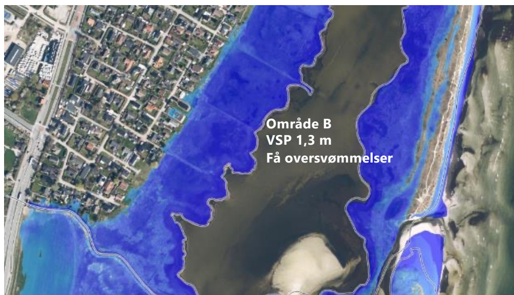
Oversvømmes ved vandstand over 1,3 m
